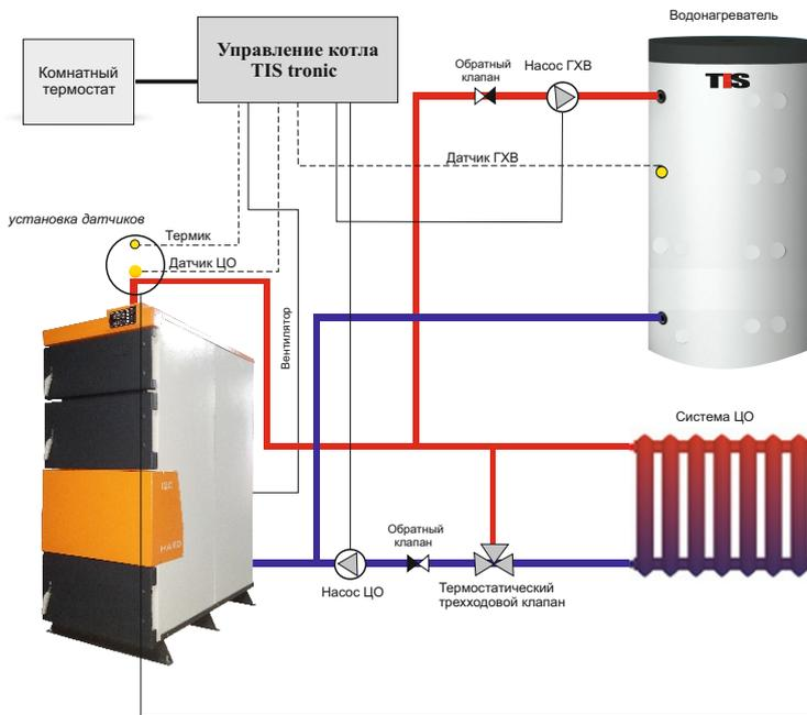
В погружную гильзу вначале опускается датчик центрального отопления, а за ним датчик термозащиты. Как вариант, допускается установка датчика термозащиты на патрубке подающего трубопровода котла (до гайки подключения), при этом, прижатие его к патрубку должно выполняться металлическим хомутом. Добавление каких-либо жидкостей в погружную гильзу запрещено!
